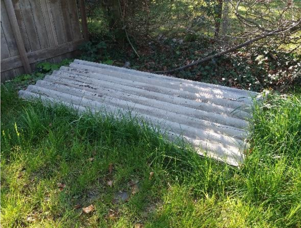
Afbeelding 4: aangetroffen asbestverdachte dakplaten in zuidoostelijke hoek van het perceel
