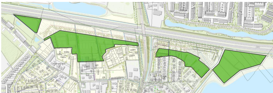
Figuur 5-2 Ligging afgravingsvlakken ten behoeve van de waterbergingscompensatie
