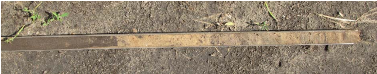
Figuur 18: Foto van boring 13 met links de bouwvoor, in het midden het deel van het opgebrachte zand dat niet in de bouwvoor is opgenomen en rechts de gelaagde beekafzettingen.
