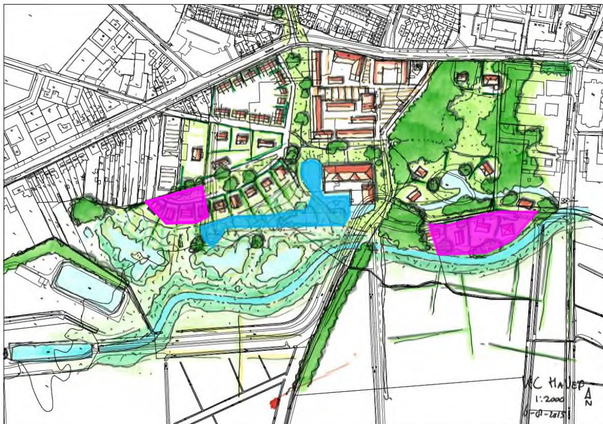
Figuur 22: Stedenbouwkundige visie (KuiperCompagnons) met inschatting op te hogen gebied (paars) en af te graven gebied (blauw)
