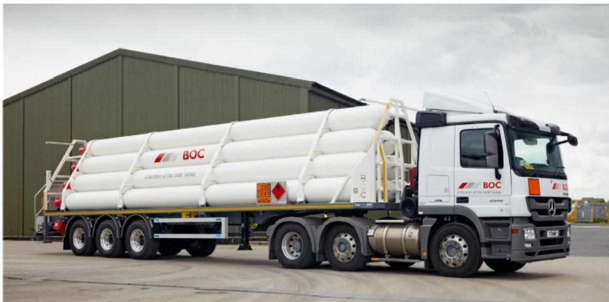
Een tube-trailer met 9 stalen drukcilinders (200 bar) (M-Tech, 2020)
